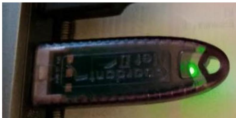
Электронный ключ подключается к порту USB и после установки соответствующих драйверов Guardant на нём включается индикатор.
