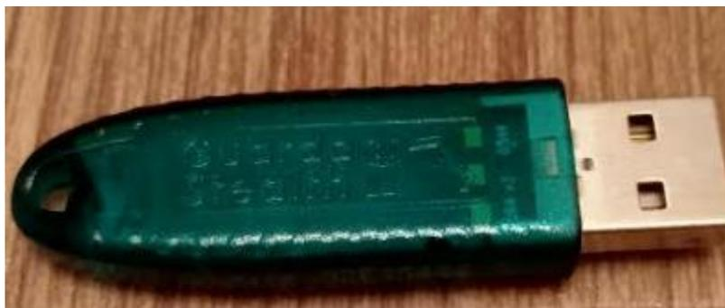
Каждый электронный ключ имеет свой идентификационный номер (ID ключа), который нанесён на его ребро (в данном случае ID ключа 32E35446).
